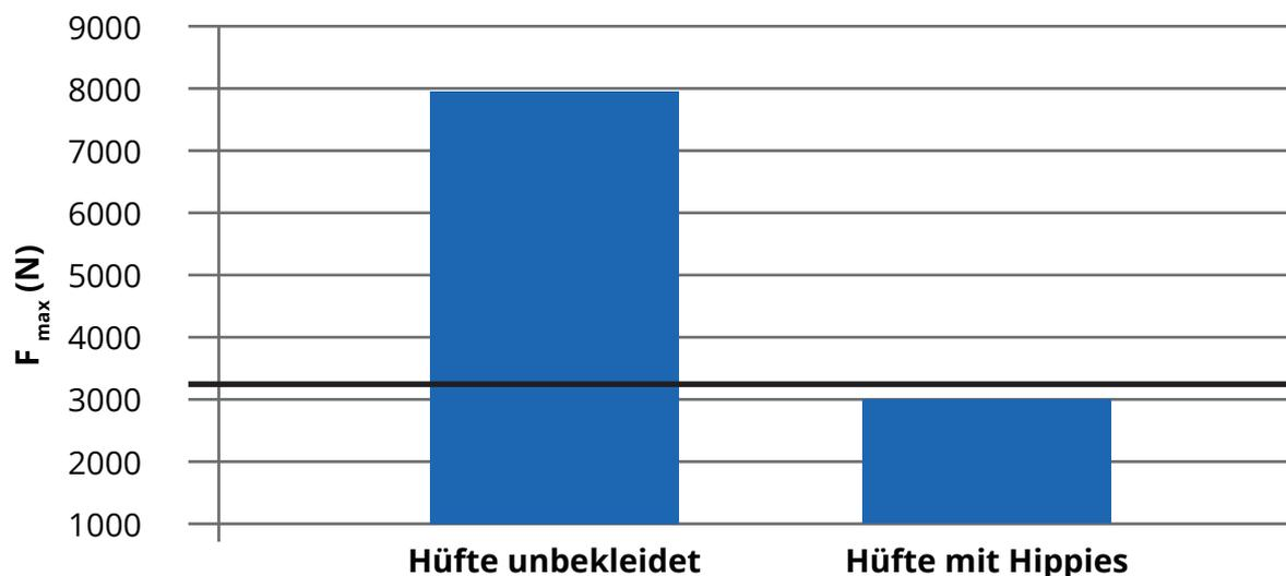
Aus den Ergebnissen geht hervor, dass die Hippies Hüftprotektoren in der Lage sind, die maximale Spitzenkraft eines schweren Aufpralls auf einen Wert von unter 3100 N zu reduzieren, dem durchschnittlichen Schwellenwert für eine Fraktur des proximalen Femur bei älteren Menschen, siehe Courtney et al. (1995).
